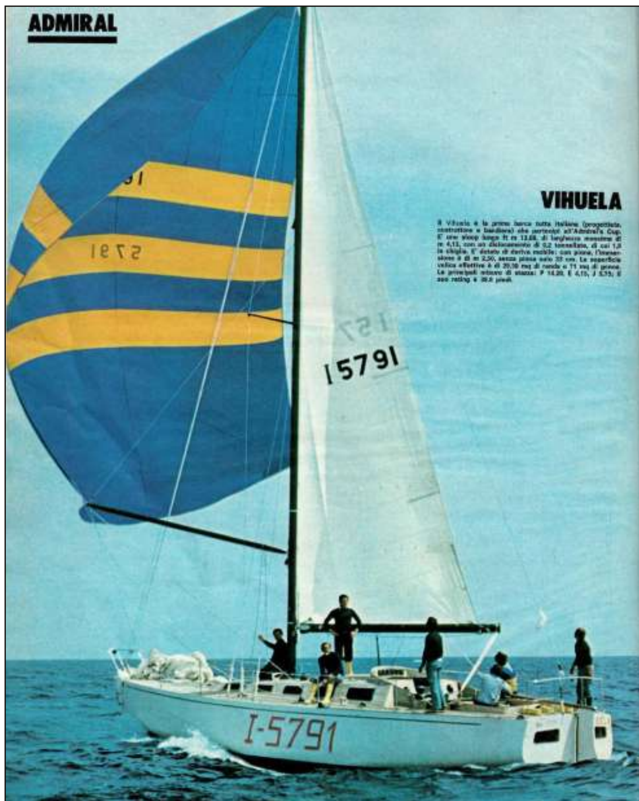
"Vihuela" con uno spi a taglio radiale ed una randa piccolissima e quasi senza allunamento. Nella nota in alto a destra si accenna ad una (inesistente) deriva mobile.
