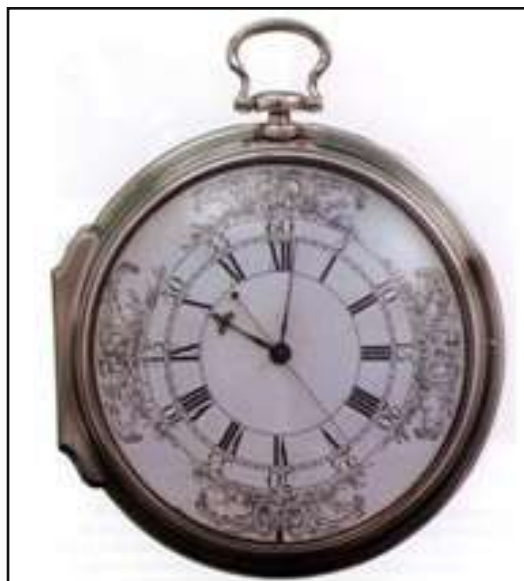
Foto 5 - Il Number Four aveva l'aspetto degli orologi da tasca dell'inizio del secolo scorso, ma il suo diametro era di 13 centimetri.
