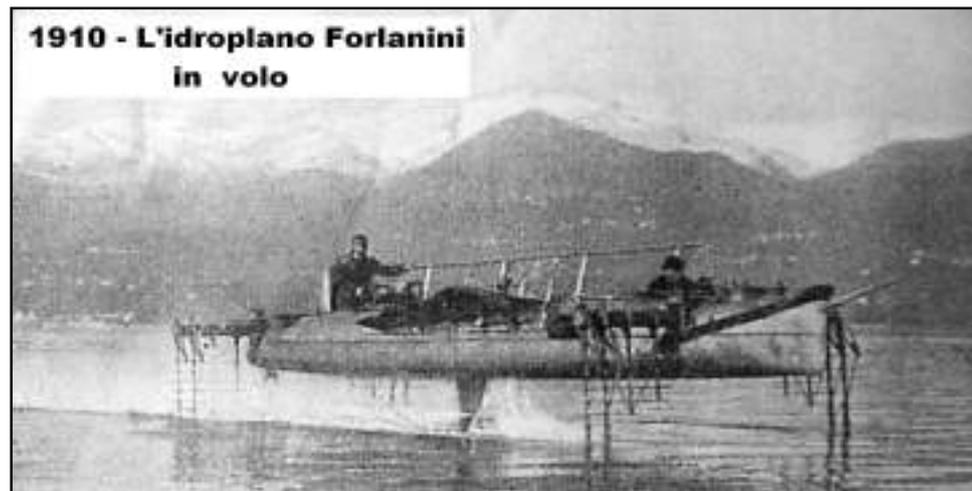
da robusti tubi di acciaio con apposite alette ed equipaggiato con motore Fiat da 100 cavalli.
