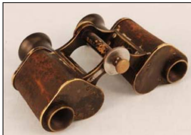
Binocolo della Zeiss del 1895 con prisma Porro.
