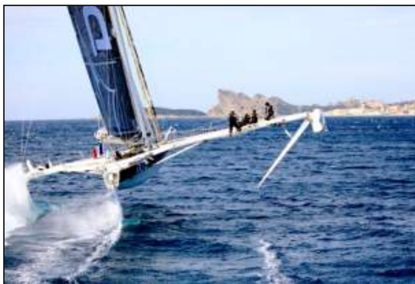
Hydroptère il trimarano capace di accelerare da 20 a 40 nodi in 10 secondi, due volte superiore all'accelerazione di un motoscafo da 250 cv.
