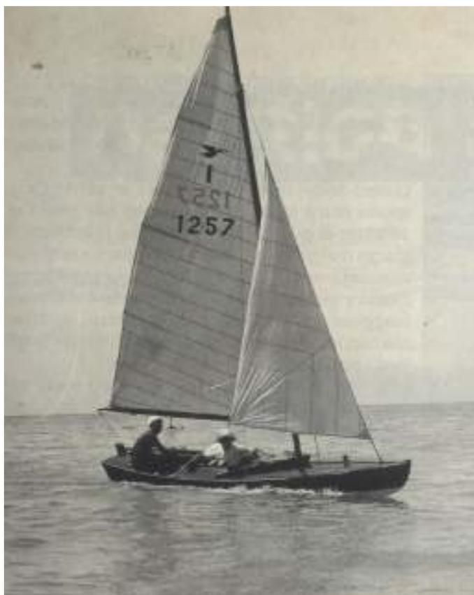
Lo scafo a spigolo, lungo 4,724 metri e largo 1,524 metri è parzialmente coperto e ha una carena a forma di V. La superficie velica era in origine di 9,29 metri quadri, è stata successivamente portata a 10,77; normalmente la superficie raggiunge gli 11,89 metri quadri con la randa e il fiocco sovrapposti. Sostanziali modifiche si sono avute nel peso: da quello iniziale di 204,11 chili a 192,8 e, all'inizio degli anni Settanta, a 172,8.
